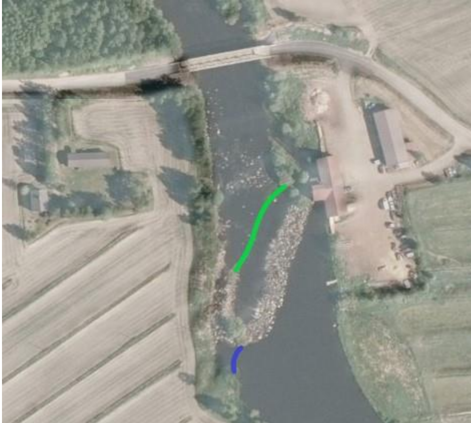
Kuva 27 Joutennivan rakennettava uusi nousureitin niska sinisellä sekä mahdollinen houkutusvirtauksia parantava kynnyks vihreällä.
