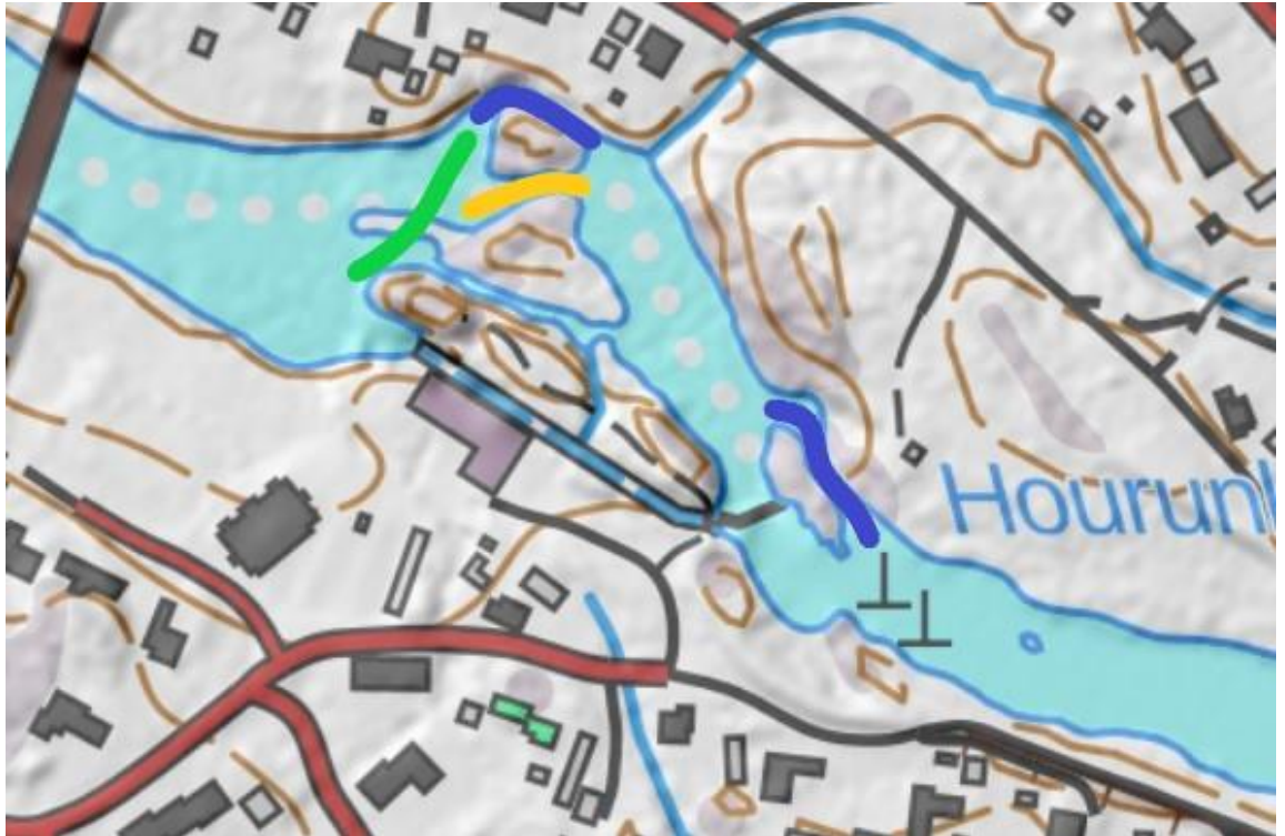
Kuva 25 Hourunkosken korjattavat kalatiet sinisellä, mahdollinen uusi kalatielinjaus keltaisella sekä muokattava alaosan virtausreitti vihreällä.
